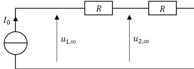
$u_{2,\infty}$  est la tension aux bornes de la résistance  $R$  et  $u_{1,\infty}$  celle aux bornes de la résistance  $2R$ . Donc :
